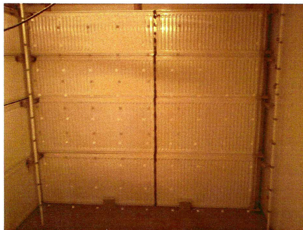
Рис. 4 — Климатическая камера с 9-ю рядами датчиков
