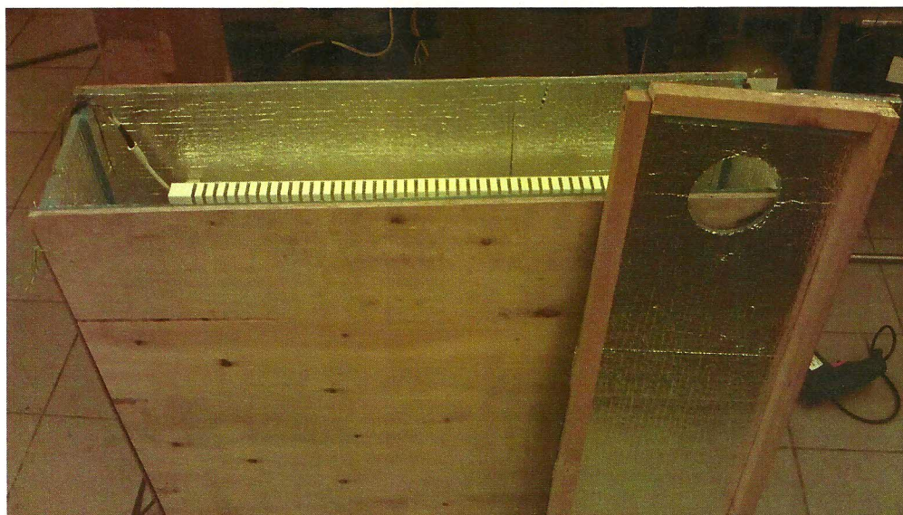
Рис. 5 — Теплоизолированный бокс для проведения калориметрических испытаний
